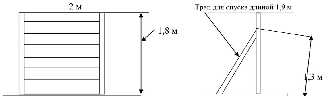
*Наклонная стенка:* высота – 1,8 (1,6) м, ширина – 1,5 м. Состоит из двух щитов шириной 1,5 м и высотой 2 м, скрепленных между собой. Щиты должны иметь поперечные планки сечением 20 x 15 миллиметра на расстоянии 0,2 м друг от друга, начиная сверху.
