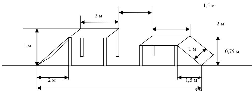
*Бум:* препятствие состоит из бревна длиной 5 м с плоским верхом и двух трапов, высота над землей 1 м, ширина плоской части бревна и трапов 0,2 м. На верхнюю поверхность трапов набивают поперечные бруски сечением 0,20 x 0,15 сантиметра на расстоянии 0,2 м один от другого, начиная сверху.
