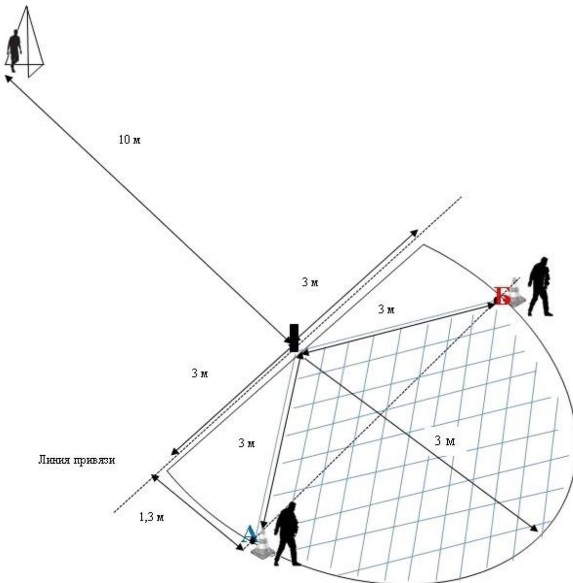
*Сектор охраны – полуокружность с углом между сторонами  $180^\circ$
